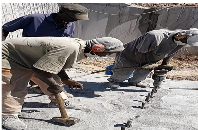
Figura 16: Uso de cunhas expansivas nos furos
