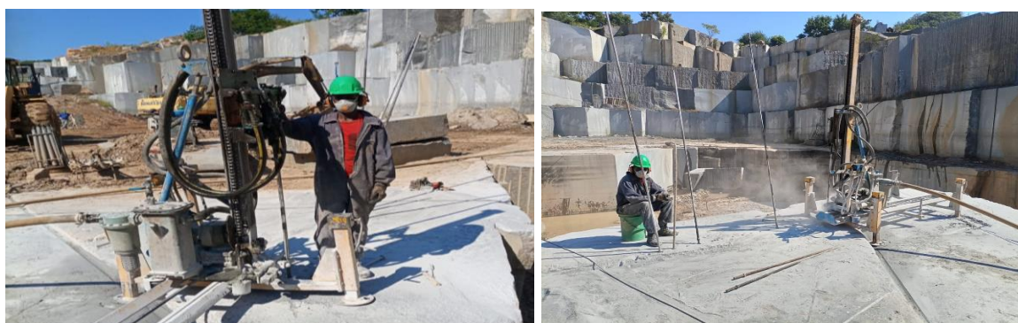
Figura 13 : Perfuração dos blocos usando uma perfuratriz pneumática (a e b)
